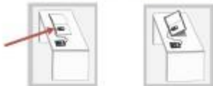
Gambar B.1 – Sensor sejajar dengan permukaan objek
